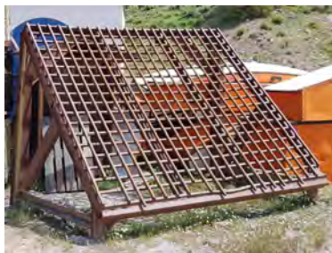
Criba de CETURSA utilizada en las obras para la obtención de gravas.
